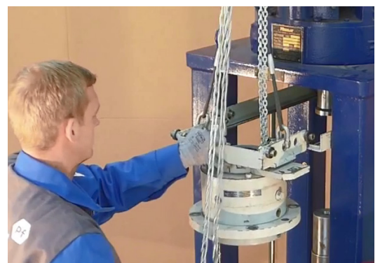
Glasringdichtungsaustausch mit Hilfe des Austauschwerkzeugs
