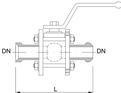
Kugelhahn, mit Glasanschluss, Typ VBG...-K
